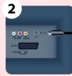
2 Подключите антенный кабель к антенному входу цифрового телевизора
